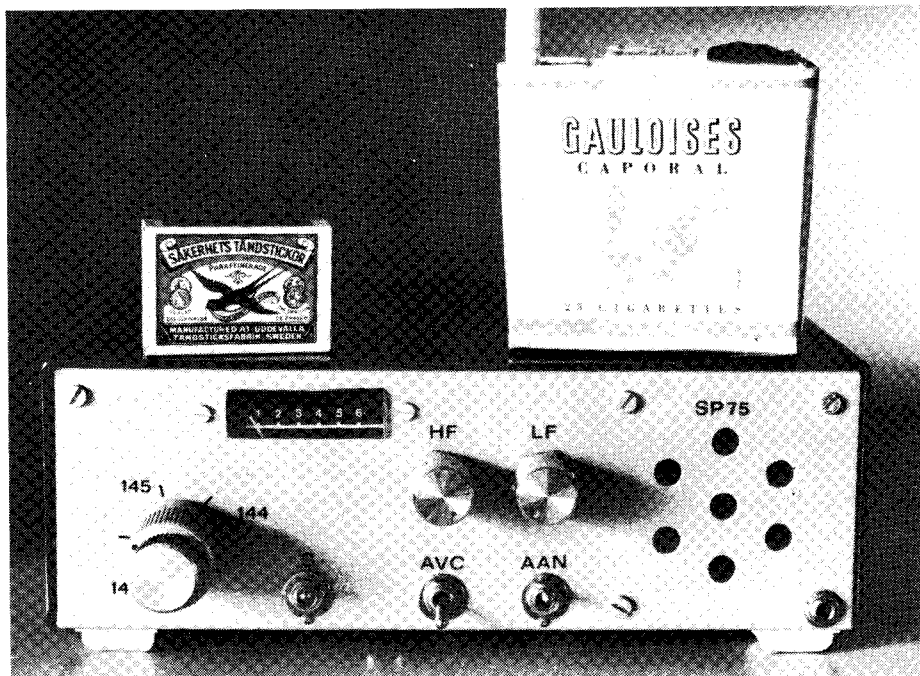
De 2 meter ontvanger SP-75. Vooraanzicht van de klein-maar-fijne ontvanger (Foto: Peter Straub)
